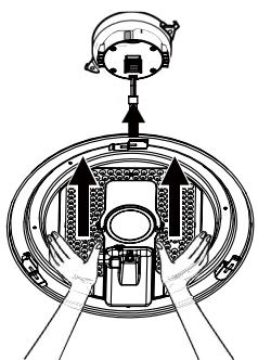
• 2回押し上げて、アダプターのツメを金属の段に取り付けてください。
