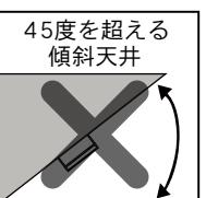
配線器具は必ず丈夫な天井面に確実に取り付けてください。
