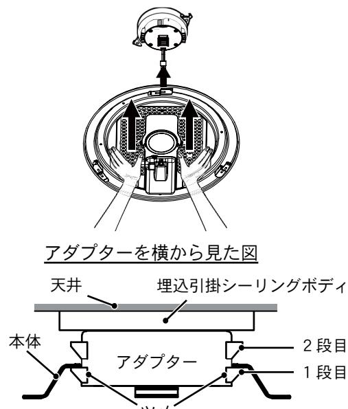
• 2回押し上げて、アダプターのツメを金属の段に取り付けてください。
